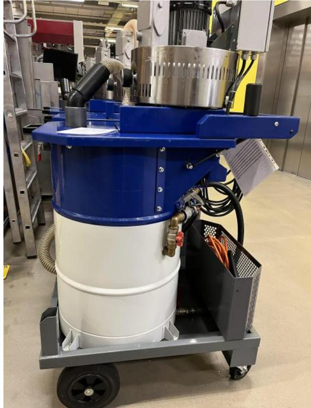
Aspirador industrial multiusos, diseñado para el vaciado de contenedores de máquinas herramienta y operaciones diarias de mantenimiento.
